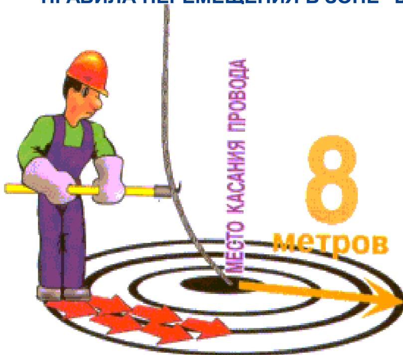
В РАДИУСЕ 8 МЕТРОВ ОТ МЕСТА КАСАНИЯ ЗЕМЛИ ЭЛЕКТРИЧЕСКИМ ПРОВОДОМ МОЖНО ПОПАСТЬ ПОД "ШАГОВОЕ" НАПРЯЖЕНИЕ. ПЕРЕДВИГАТЬСЯ В ЗОНЕ "ШАГОВОГО" НАПРЯЖЕНИЯ СЛЕДУЕТ В ДИЭЛЕКТРИЧЕСКИХ БОТАХ ИЛИ ГАЛОШАХ ЛИБО "ГУСИНЫМ ШАГОМ" - ПЯТКА ШАГАЮЩЕЙ НОГИ, НЕ ОТРЫВАЯСЬ ОТ ЗЕМЛИ, ПРИСТАВЛЯЕТСЯ К НОСКУ ДРУГОЙ НОГИ.
